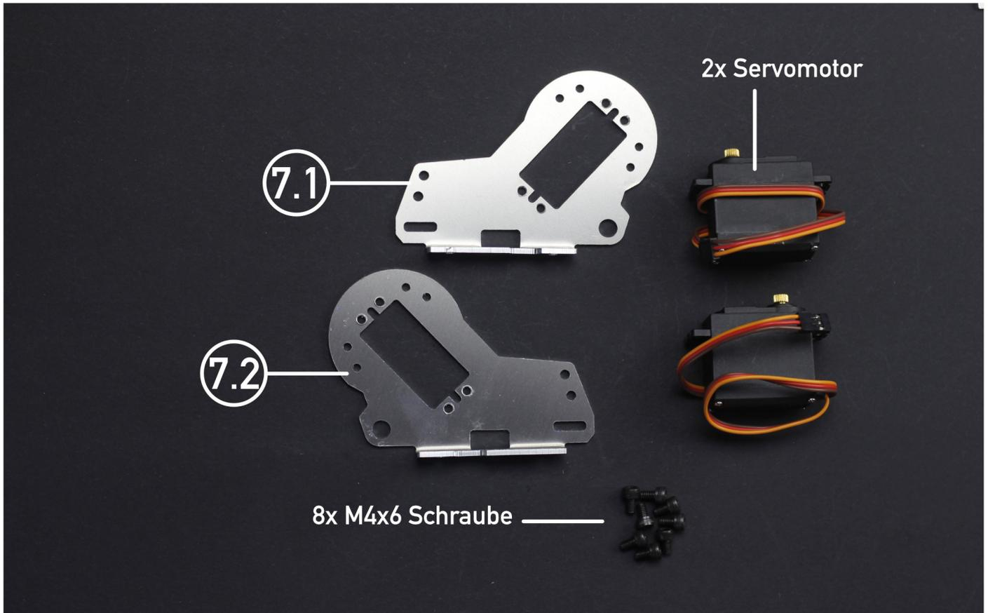
**5** Servos so an den Bauteilen 7 montieren, dass sich der gekantete Schenkel auf der Abtriebseite des Motors befindet. Zudem muss die Motorwelle sich in der am weitesten vom Schenkel entfernten Psoition befinden.
