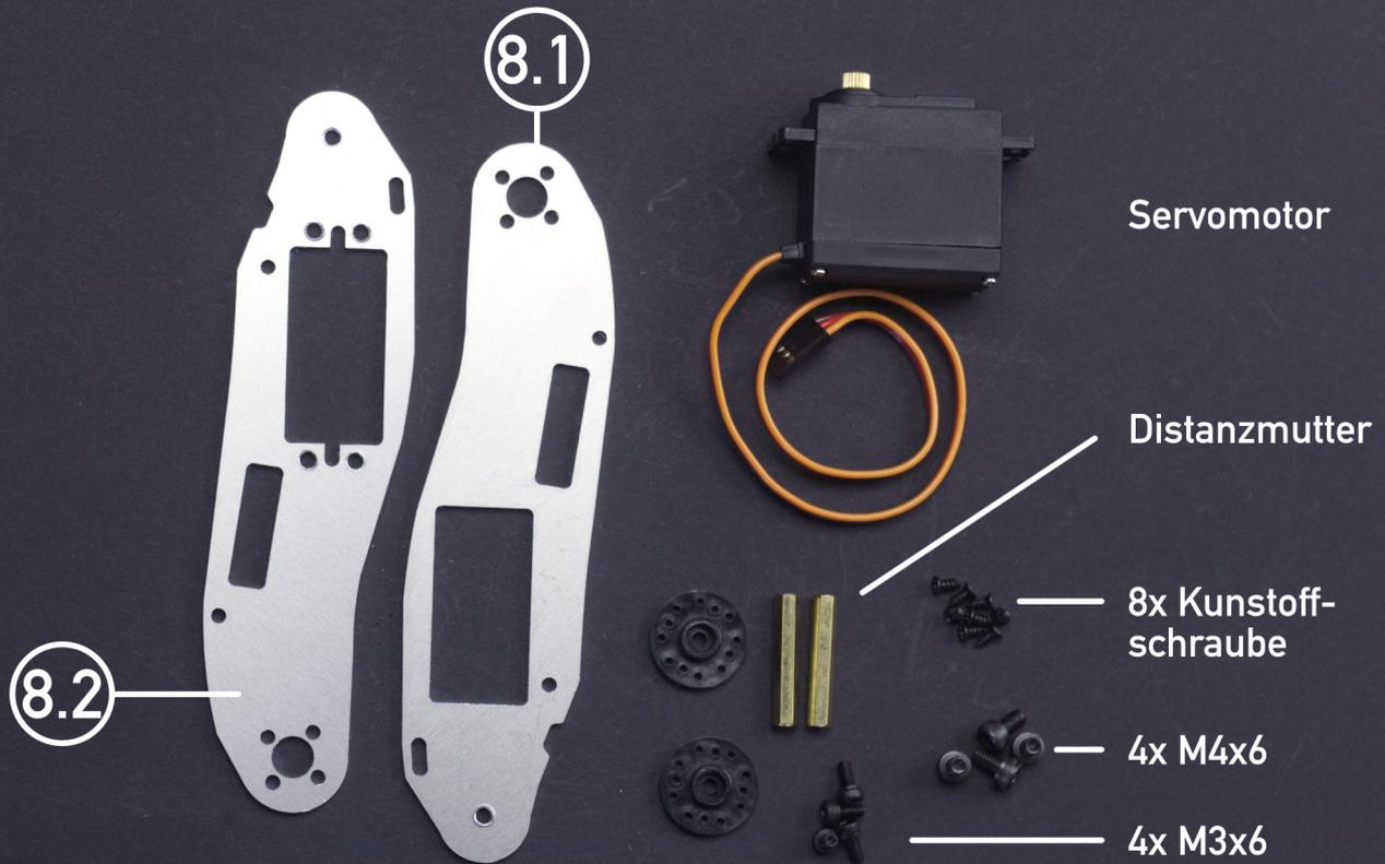
**6** Kunststoffflanschteile mit Hilfe von jeweils vier Kunststoffschrauben, wie abgebildet, an den Teilen 8.1 und 8.2 befestigen.
